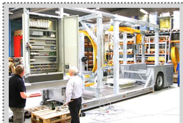
Rittal el-skab monteret på mobilt anlæg til strækfilm-emballering af affald på den britiske Kanalø Jersey. Anlægget består af en strækfilmvikler med tilhørende transportudstyr, opbygget på et sættevognschassis.
